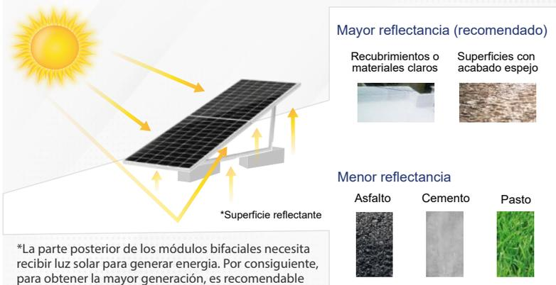
\*La parte posterior de los módulos bifaciales necesita recibir luz solar para generar energía. Por consiguiente, para obtener la mayor generación, es recomendable que se instalen en superficies con mayores propiedades reflectantes (mayor albedo) y exista la separación del suelo necesaria para garantizar una mayor proyección de la luz.
