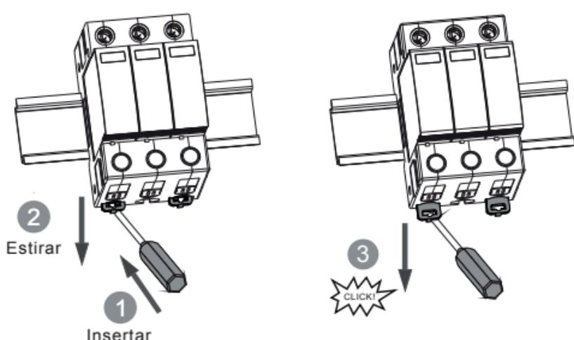
Para desmontar la base del riel din es necesario un desarmador. Como lo muestra la imagen, debemos de quitar los seguros con cuidado para que la base pueda ser desmontada del riel din.
