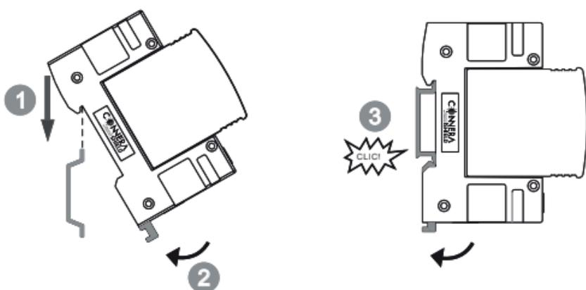
El montaje es muy sencillo, debemos de colocarlo de la parte superior ① y oprimir hasta que escuchemos un clic! Con estos sencillos pasos nuestro supresor de picos quedará instalado.
