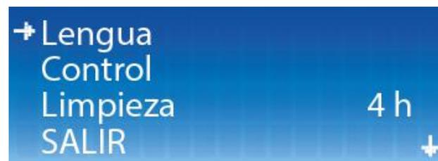
Con los botones **↑** **↓** podemos seleccionar una línea del menú, que viene indicada por la flecha (→). El botón **OK** sirve para confirmar la selección. Para acceder al menú de configuración, es necesario confirmar la operación seleccionando (S) mediante la flecha **↑** y pulsando **OK**.
