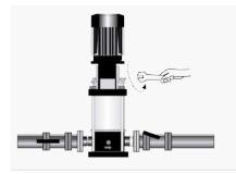
Paulatinamente abra completamente la válvula de descarga mientras purga el aire.
