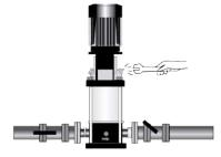
Abra la válvula de descarga y permita salir el aire de la bomba.
