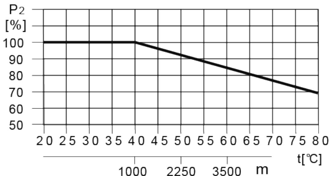
De la figura anterior, si la motobomba se instala a una altitud de 3500 metros, P2 disminuirá a 88%, pero si la temperatura ambiente es de hasta 70 °C, P2 disminuirá a 78%
