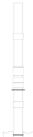
6. Cuando ya se haya colocado el último tubo de la columna, a su salida se debe de colocar el adaptador superior que es instalado en la tapa del pozo para soportar la columna y facilitar la conexión con la red exterior de tubería.
