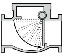
En las válvulas de retención tipo columpio, la válvula se cierra a lo largo de un camino de 90° después de que el flujo llega hacia atrás.
