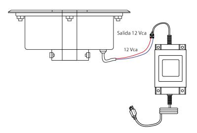
Localice las terminales de salida del transformador (12 Vca) y conecte los dos cables de alimentación a su correspondiente tablilla. Conecte los cables del burbujeador a la tablilla de salida del transformador, puede colocarse en cualquier orden ya que no tiene polaridad.
