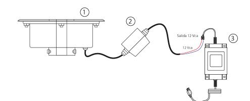
En este modelo el controlador de luz del burbujeador viene de manera externa, conecte los cables del controlador de luz a la tablilla de salida del transformador (12 Vca), puede colocarse en cualquier orden, ya que no tiene polaridad.
