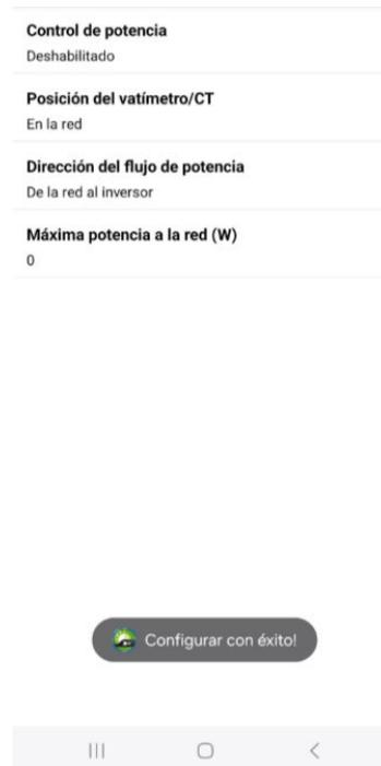
**Paso 5)** En el campo Control de potencia, selecciona la opción Sensor CT para activar la función de inyección cero. Esta configuración permite que el inversor limite la energía entregada a la red en función del consumo real de la instalación.
